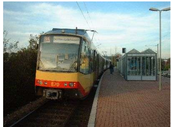
ドイツ・カールスルーエのトラム / 路面軌道と郊外鉄道を行き来する LRT の代表事例 撮影：清水省吾
